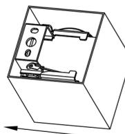
7、将卡槽中间对准支架内边（双头）推动灯具滑动。
