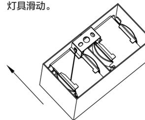
8、将灯具滑动到底，确认完成固定。
